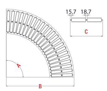
ROLLER SITS ABOVE CHANNEL STEEL ROLLER 50MM DIAMETER ROLLER PITCH 75MM
